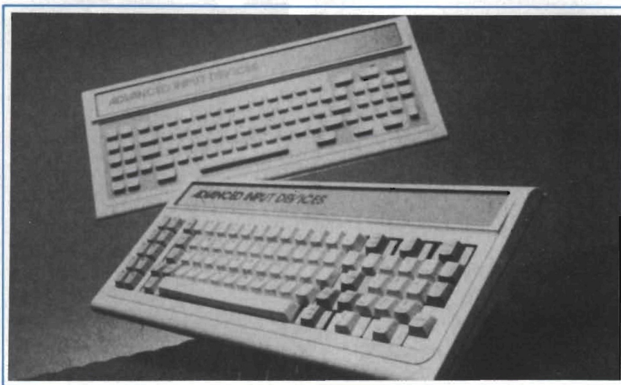
Tastiera dell'Advanced Input Devices, IBM-compatibile con tecnologia ad elastomeri. Completamente sigillata, ha una vita utile di 60 milioni di cicli operativi, per ciascun tasto.
